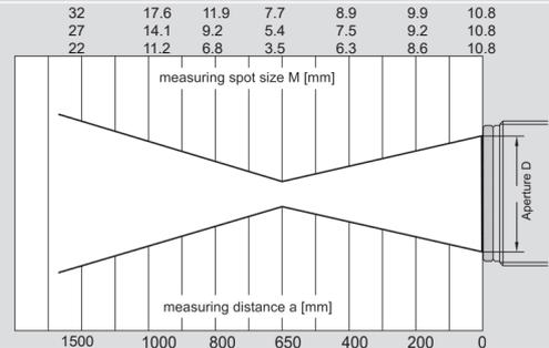
**Optics 1500** (a = 1500 mm 측정 거리에서의 sharp point, 조리개  $\varnothing D = 10.4$  mm)
