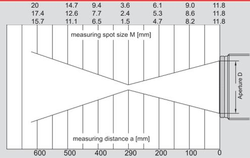
**Optics 650** (a = 650 mm 측정 거리에서의 sharp point, 조리개  $\varnothing D = 10.8$  mm)
